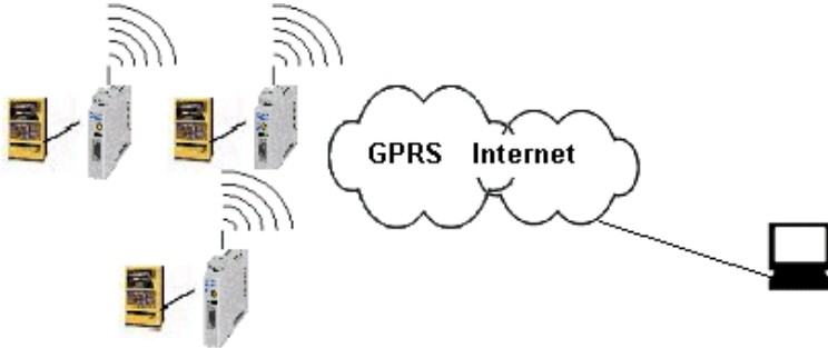
TAINY ComPortServer mit Applikation, z. B. Leitstellen-Software
